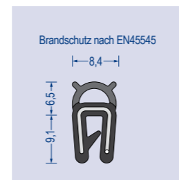
Artikel-Nr. 561.8249 EPDM-Weichgummi/ EPDM-Moosgummi · schwarz Brandschutzqualität nach EN 45545 Klembereich 1-2mm VE: Bund á 50m
