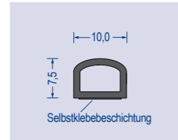
Artikel-Nr. 588.6672 EPDM · schwarz mit Hohlkammer VE: Spule á 150m als Montagehilfe einseitig selbstklebend
