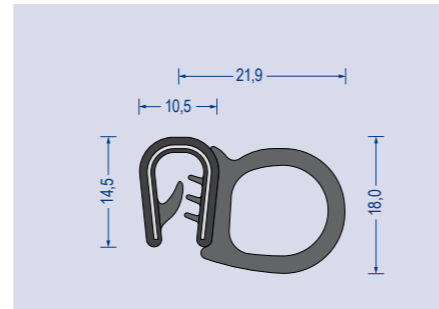
Artikel-Nr. 561.2438 Weich-PVC/EPDM-Moosgummi · schwarz Klemmbereich 2-5mm VE: Bund á 50m
