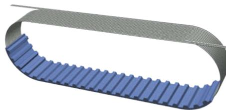
Aufbau des **optibelt ALPHA FLEX** Zahnriemens mit schraubenförmig aufgewickeltem S+Z-Zugstrang und extrudiertem, geformtem Polyurethan
