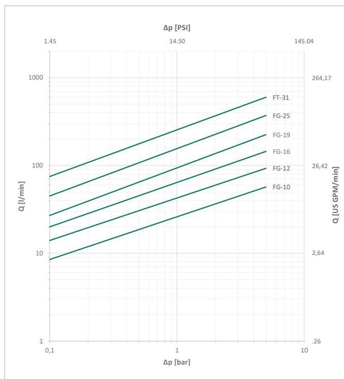
Bitte beachten Sie: Sofern nicht anders angegeben, gelten die Kennlinien für Hydrauliköl mit einer kinematischen Viskosität von 28,8 - 35,2 mm²/s (28,8 - 35,2 cSt) und nur für Kupplungen mit nicht reduzierten Anschlüssen.
