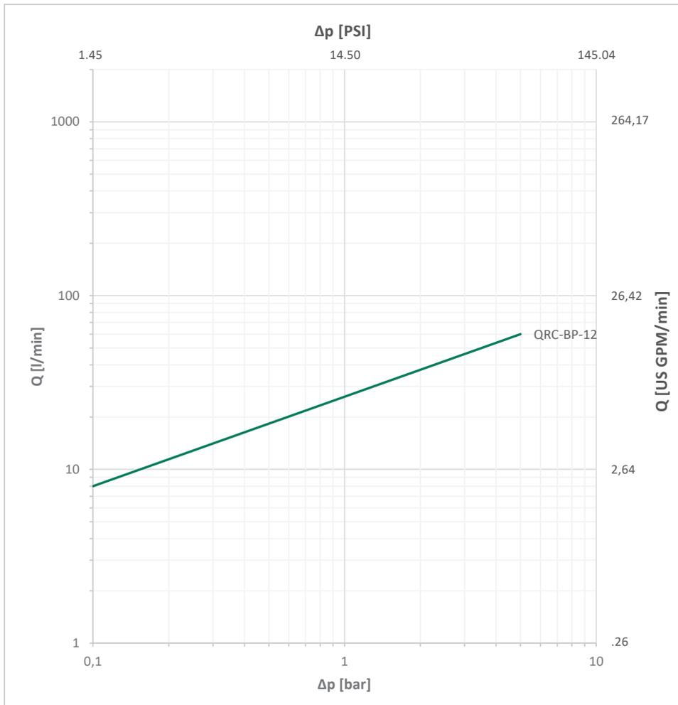
Bitte beachten Sie: Sofern nicht anders angegeben, gelten die Kennlinien für Hydrauliköl mit einer kinematischen Viskosität von 28,8 - 35,2 mm<sup>2</sup>/s (28,8 - 35,2 cSt) und nur für Kupplungen mit nicht reduzierten Anschlüssen.
