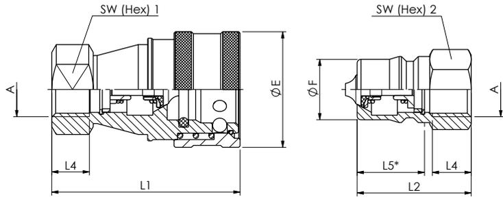
Alle Abmessungen in mm (inch). Zeichnung entspricht Serie IB-12.
