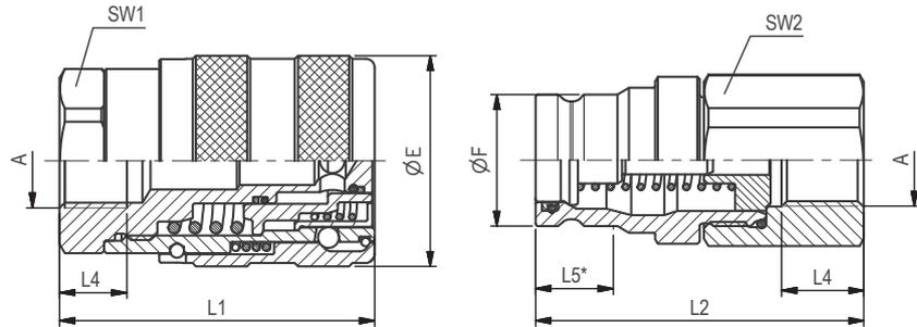
Alle Abmessungen in mm (inch). Zeichnung entspricht Serie FO-12.
