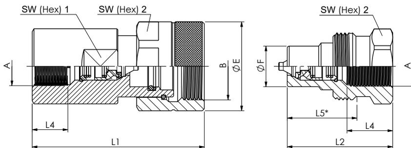
Alle Abmessungen in mm (inch). Zeichnung entspricht Serie HH-12.
