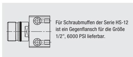
Hinweis: Das Verbinden der Kupplungshälften erfolgt je nach Bauart. Hierbei ist auf das vollständige Einrasten bei Steckkupplungen bzw. auf die vollständige Verschraubung der Schraubhülse bis auf Anschlag zu achten. Das gewaltsame und nicht sachgemäße Trennen der Verschlusskupplung führt zu Funktionsstörungen.
