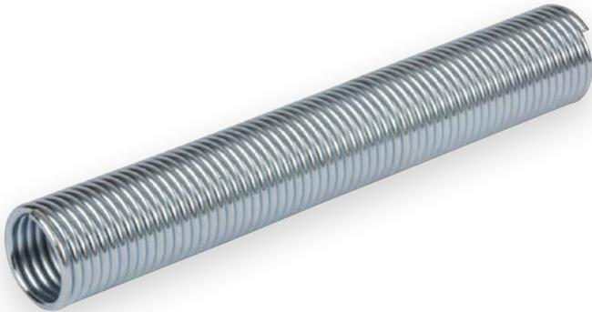
**Schutzwendel aus verzinktem Federstahldraht zur Vermeidung von Beschädigungen an Schlauchleitungen durch Scheuerbeanspruchung und vor Abknickung hinter der Fassung.**
